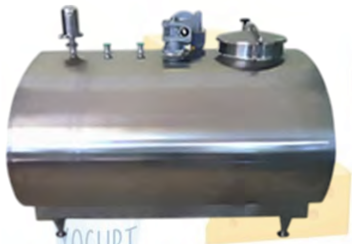
TANQUE DE ENFRIAMIENTO DE LECHE SUS304
